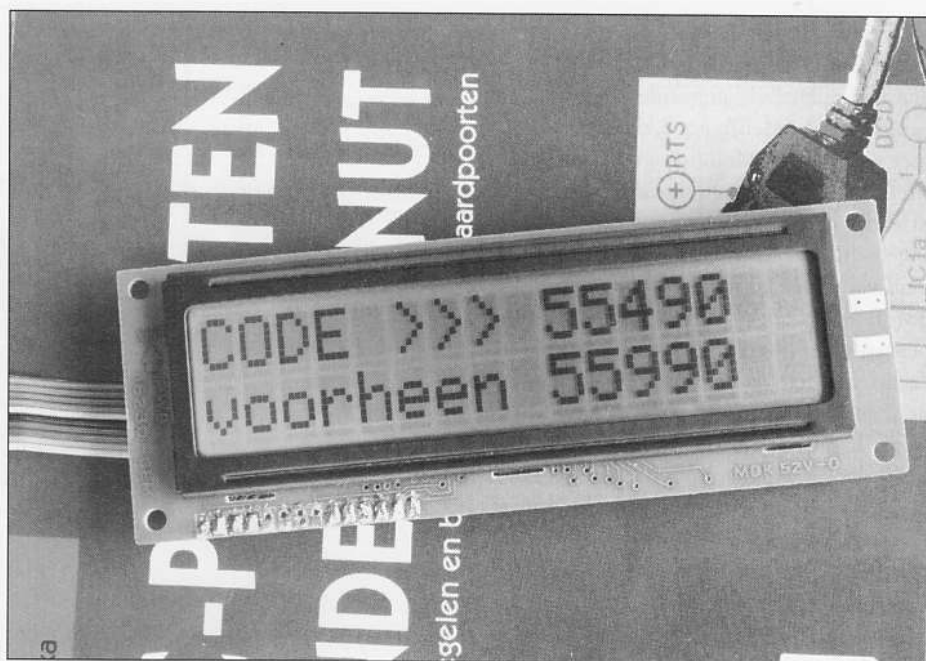
De display (LCD) van ons testexemplaar heeft 2 regels van 16 karakters. Optioneel zijn displays van 20 of 40 karakters leverbaar.
